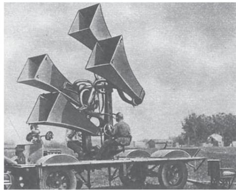
Станции-искатели монтировались на базе автомобилей ЗИС-5. Один грузовик был с прожектором открытого типа, а вторая машина — со звукоуловителем
