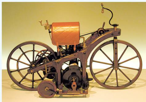
пронёсся первый в мире мотоцикл. Он представлял собой оригинальный велосипед с мотором. Рама и колёса были изготовлены из дерева. Колёса были не два, а четыре, и сверху они были обиты железом. Под сидением располагался двигатель внутреннего сгорания мощностью 0,5 лошадиных сил. В качестве топлива мог быть использован бензин или керосин. Примерно за одну минуту заводной рукояткой запускали двигатель.
